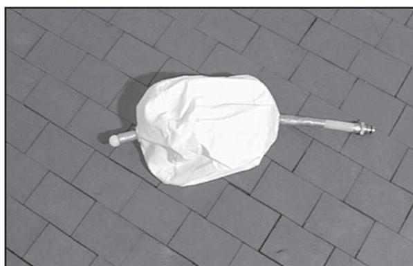
Одиночная воздушная запорная камера без измерения давления в перекрываемом трубопроводе
