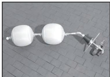
Воздушные запорные камеры с **усиленной** оболочкой, характеризующейся долговременным сохранением антистатических свойств. Для давления до 1 бара. С гибкими направляющей и заполняющей штангами. В комплекте резиновая заглушка-переходник конической формы, 2 манометра и 2 шаровых крана. У каждой из камер в составе одной пары собственный отдельный подвод воздуха.
