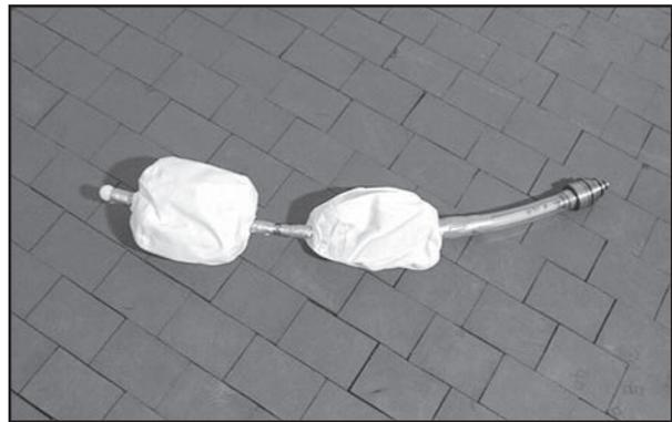
Сдвоенные воздушные запорные камеры с дополнительным сбросом давления из промежуточного пространства.
