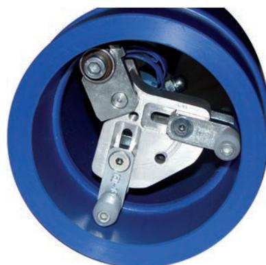
Режущие головки для труб с наружным диаметром 125 – 450 мм
