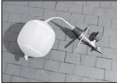
Воздушные запорные камеры с **усиленной** оболочкой, характеризующейся долговременным сохранением антистатических свойств. Для давления до 1 бара. С гибкими направляющей и заполняющей штангами. В комплекте резиновая заглушка-переходник конической формы, манометр, шаровой кран.
